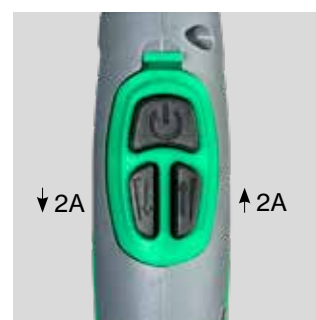
Up/Down modul med 3-knapps- avtryckare för justering av svets- ström. Svetsströmmen ökas/minskas med 2 ampere. Långt tryck för konstant ökning/minskning.
