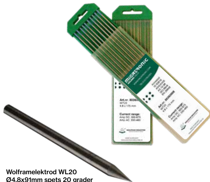
Lågkvalitets-wolfram: Ljusbågen tänds oftast från sidan, ljusbågen flackar och vandrar endast långsamt till elektrodspetsen, som skall skäras av och tillspetsas igen
