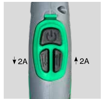
Module 3 touches pour le réglage du courant de soudage. Augmentation/diminution du courant de soudage de 2 ampères. Appui long pour augmentation/diminution en continu. Réf. n°.....80300064* * S'applique aux versions logicielles à partir de 2.17
