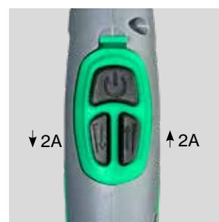
Spínač Up/Down se 3 tlačítky, spínání a nastavování svařovacího proudu. Růst/pokles proudu skokově po 2A. Podržení plynule zvyšuje/snižuje proud. Obj. č. ....80300064* * Pro zdroje s verzí software 2.17 a vyšší
