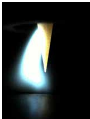
Wolfram nízké kvality: typické zapálení bočního oblouku, který bliká a přibližuje se postupně k hrotu elektrody. Oblouk musí být zhasnut a elektroda uzemněna.
