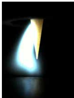
Tungsteno di bassa qualità: accensione dell'arco tipicamente laterale; l'arco lampeggia e devia lentamente verso la punta dell'elettrodo che deve essere tagliata e riaffilata.
